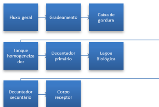
Figura 12 - Etapas realizadas para tratar o efluente do fluxo geral.
