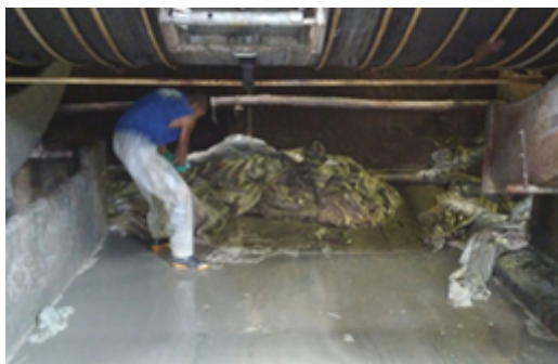
Figura 9 - Pele passando pelo processo de caleiro e depilação.
