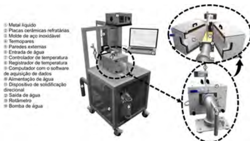
Figura 1. Representação esquemática do dispositivo de solidificação horizontal. Fonte: Adaptado de Lima et al. (2018).
