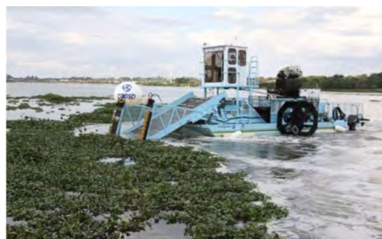
Figura 2. Embarcação especial para a remoção de macrófitas no Lago Paranoá, em Brasília.
