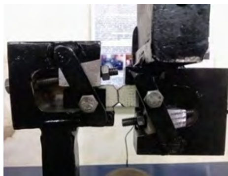
Figura 12. Garras superior e inferior com acessórios e corpos de prova.
