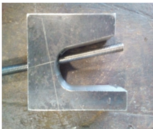
Figura 07. Foto da fabricação da garra.
