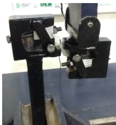
Figura 13. Garras e máquina preparada para teste.
