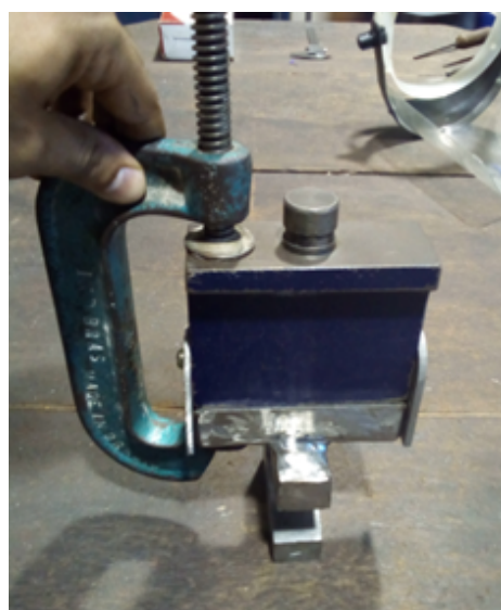
Figura 09. Travamento da peça antes de iniciar o processo de soldagem.
