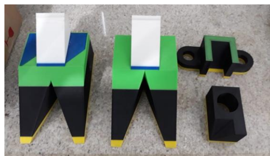
Figura 01. Peças geométricas construídas na impressora 3D
