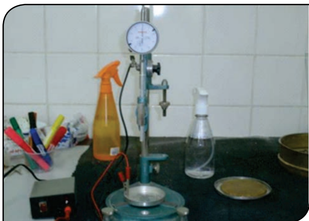
Figura 2 – Penetrômetro da Solotest fabricado para o Método das Pastilhas.
