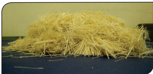
Figura 3. Fibra de sisal com 25 mm.
