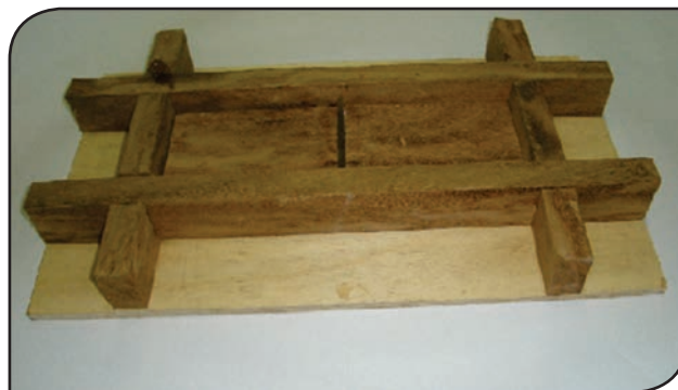
Figura 7. Molde do corpo de prova em madeira. Fonte: PERES, 2010.
