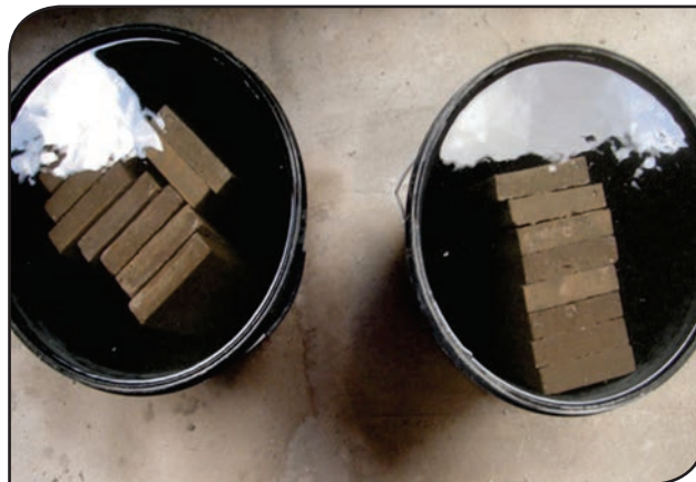
Figura 9. Corpos de prova imersos na água.
