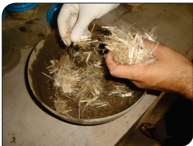
Figura 8. A fibra sendo adicionada à mistura da argamassa de cimento.
