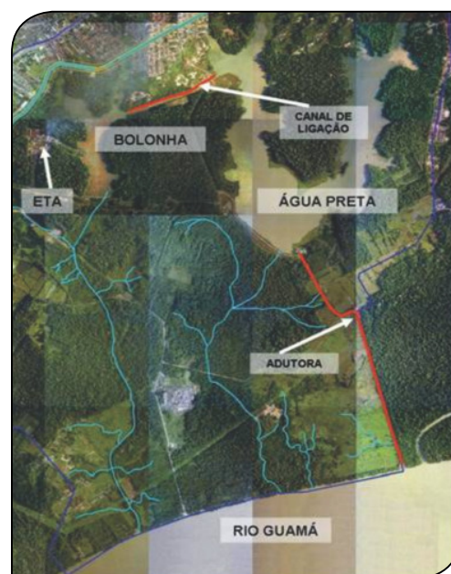
Figura 1 — Sistema de captação e armazenamento de água superficial. Fonte: CODEM (1998).
