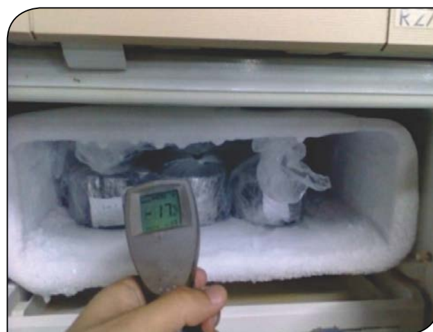
Figura 10 — Corpos-de-prova isolados em filme plástico para congelamento.
