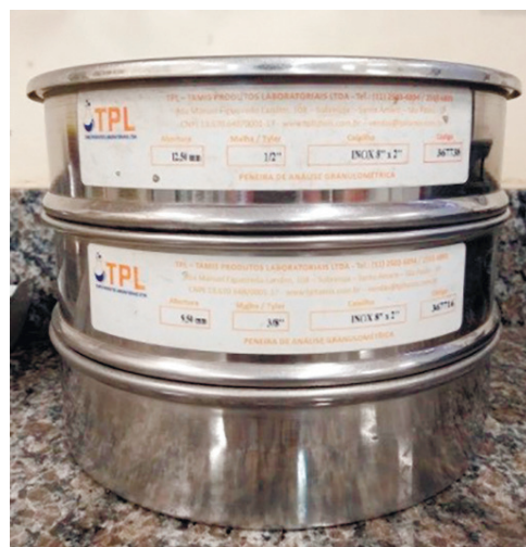
Figura 04. Malha 3/8", abertura 9,5 mm.
