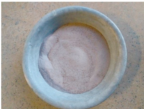
Figura 06. Areia, passante na malha nº 8, abertura 2,36 mm.
