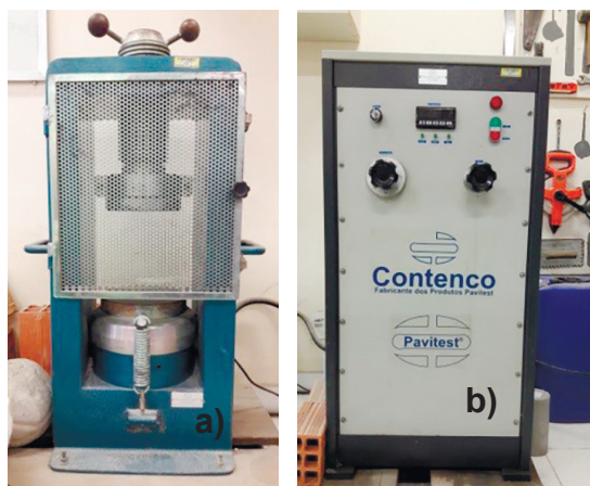
Figura 19. a) Estrutura de compressão, capacidade máxima de 100 toneladas; b) Gabinete de comando, precisão \pm 1\% a partir de 20% da escala.
