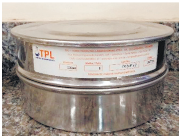
Figura 05. Peneira de malha nº 8, abertura 2,36 mm.
