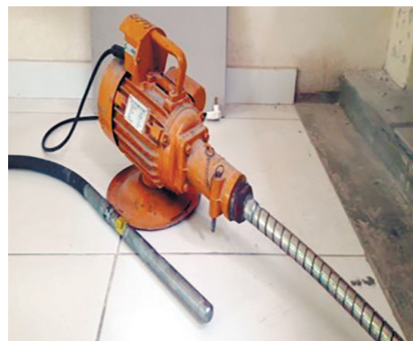
Figura 15. Vibrador de imersão Electric Motor ZN-G, 110 v.
