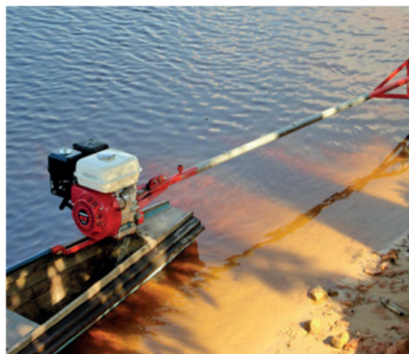
Figura 2. Conjunto configurativo do eixo e do motor da rabeta.
