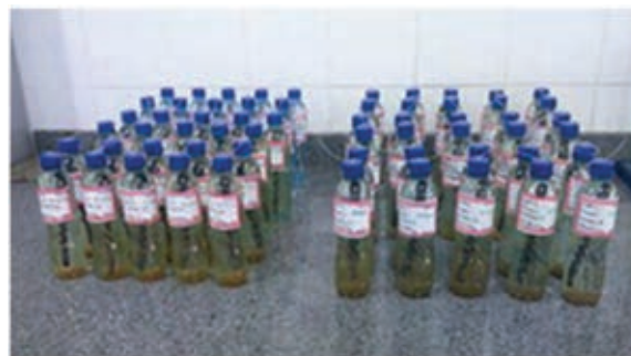
Figura 6. Corpos de provas usinados e imersos em solução salina no ensaio de perda de massa.
