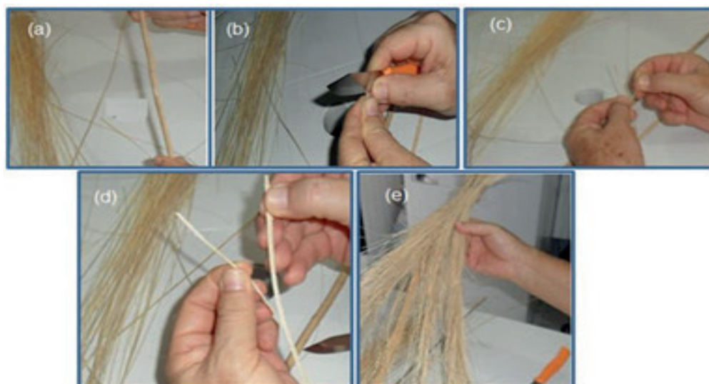
Figura 07. Sequência do processo manual para obtenção das fibras de timbó-açu: (a) amostra do cipó; (b) bipartição com lâmina de faca; (c) e (d) desfibramento; (e) maço de fibras retiradas de um cipó.
